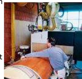
Die Vakuumform wurde mit der Funktion „Negativform“ in TopSolid'Wood konstruiert und auf diesem Fünfachs-BAZ von Morbidelli gefertigt
